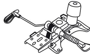
**Mecánismo** de dos palancas para ajuste al altura en inclinación del espaldar con sistema sincro que permite un movimiento coordinado del asiento y del respaldo con bloqueo y antirretorno de seguridad.
