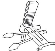
**Mecánismo** de dos palancas que permite el ajuste en **altura** del espaldar con sistema sincro automático que permite un movimiento coordinado del asiento y del respaldo con bloqueo y antirretorno de seguridad.
