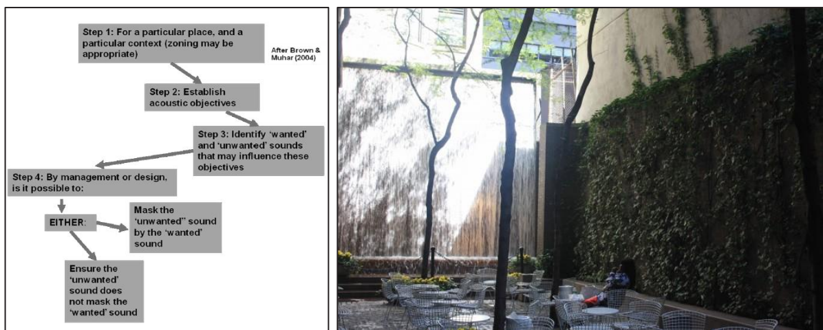
Figuur 33 Overzicht van stappen voor akoestisch ontwerp van een buitenruimte, overgenomen van [31], en een voorbeeld van een urban landscape design waarbij een waterval en groene wand het buitengeluid reduceren.
