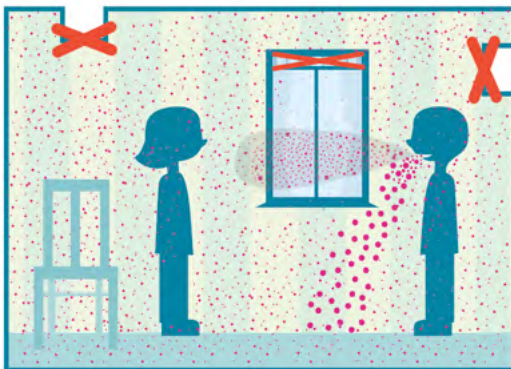
Geen ventilatie of verluchting
