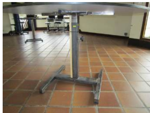
In hoogte verstelbare tafel, aanpasbaar voor verschillende rolstoelgebruikers en vrij van een hinderend onderstel.
