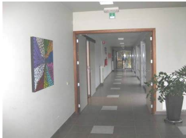
De sasdeuren in deze gang zijn even breed uitgewerkt als de gang. Stijn vzw, © Enter vzw
