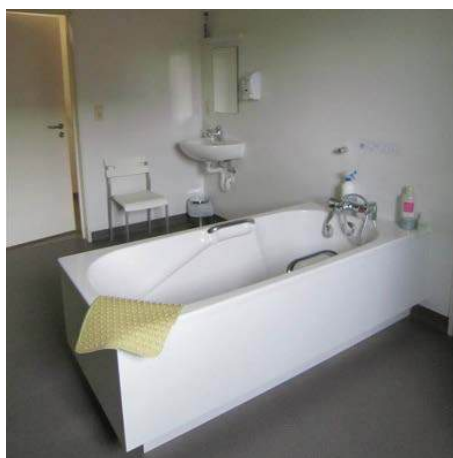
Vrijstaand bad op normale hoogte, met ingewerkte handgrepen en onderstaanbaar uitgevoerd. Zorgcentrum Maria - Ter - Engelen vzw, © Enter vzw
