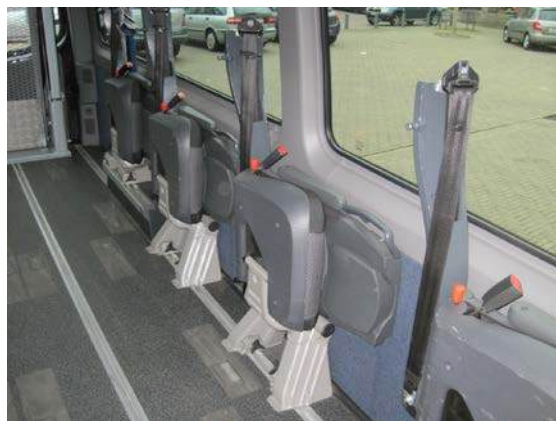
Binnenzijde van een liftbus met opklapbare zetels.
