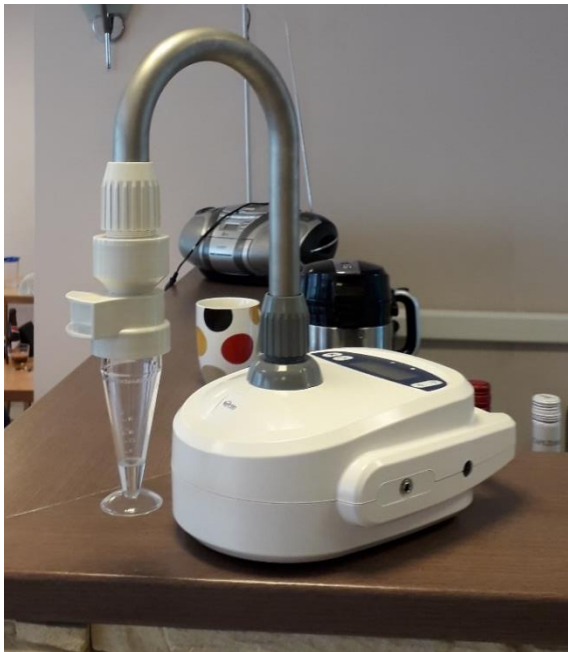
Figuur 4. De Coriolis \mu , gebruikt voor het bemonsteren van virusdeeltjes in lucht.
