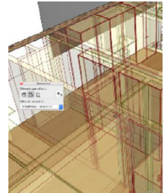
In het Dethy-project werd via een 3D-scan een BIM-model opgemaakt, waaruit de exacte hoeveelheden konden worden gehaald inzake af te breken, te behouden en nieuwe materialen. © Lionel BOUSQUET
