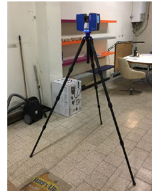
In het Dethy-project werd via een 3D-scan een BIM-model opgemaakt, waaruit de exacte hoeveelheden konden worden gehaald inzake af te breken, te behouden en nieuwe materialen. © Lionel BOUSQUET
