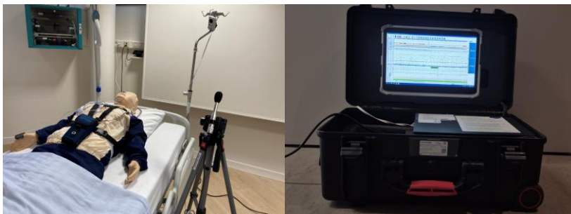
Figuur 1 Links: Opstelling van de tweede geluidssensor en camera aan het hoofdeinde van het bed en een levensgrote dummy pop waarop de set-up voor een slaaponderzoek werd aangebracht. Rechts: De slaapsensorkit die gratis ter beschikking werd gesteld door OSG/Natus.
