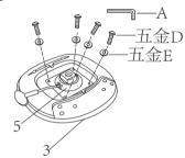
将底盘放置在座垫的中心位,使用五金D.E对准座垫 的孔位锁紧固定
