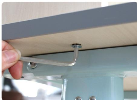
第十一步 将装好的书架整体放到装好的桌面上 对准孔位, 然后用螺丝C固定拧紧 11.Put the installed bookshelf on the table and align the holes,then tighten the screw C.
