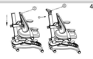
将旋钮放松后拔出一点后将靠背插入到管柱里 后再适当拧紧旋钮并把推把装如管柱内并用自 攻螺丝拧紧即可,如下图所示!
