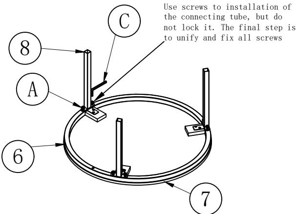
用螺丝安装连接管，但不要锁紧，最后一步是统一和固定所有螺丝。
