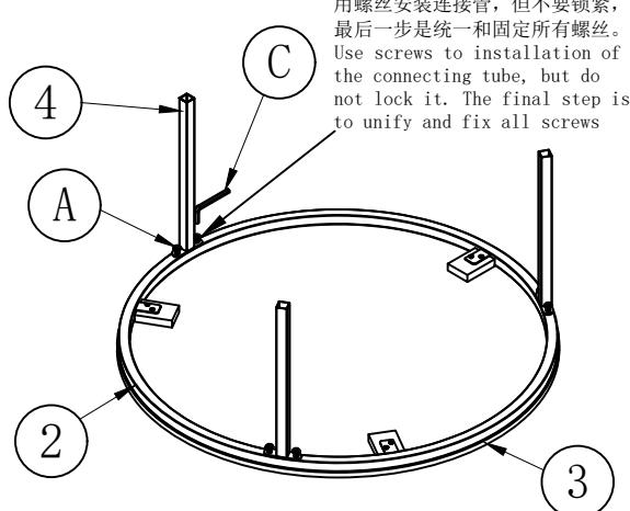
用螺丝安装连接管，但不要锁紧，最后一步是统一和固定所有螺丝。
