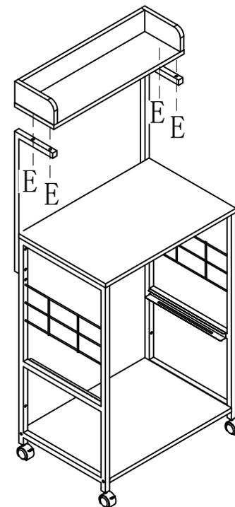
安装⑨号部件上层底板时,白板带内嵌螺母一面应朝下安装。
