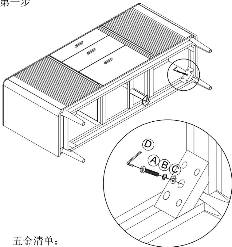
第二步: 使用自攻丝将连接铁片固定上下节
