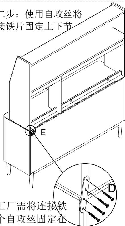
注意: 工厂需将连接铁片用一个自攻丝固定在侧山后端发货
