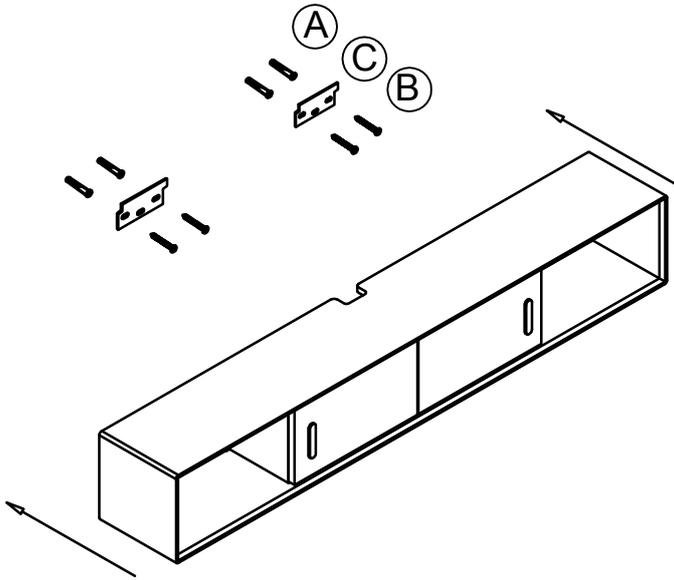
第二步：侧板上的挂码挂在墙体上挂板上面，装饰盖可推入安装好
