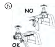
6 För att förhindra snedvridning och skada på ventilens delar, sätt ej ventilen i skruvstycke på arbetsbänk. Sätt hellre røret i skruvstycket och skruva skjutventilen på plats.
