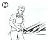
2 Rensa røret före användning. Materialrester och smuts är ofta orsaken till lekkage i ventiler.
