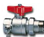
Kulventil, inv/utv gg med kopplingsmutter och avtappning, mässing.
