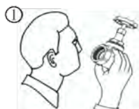
1 Inspektera skjutventilens gängor på smuts innan montering. Smuts kan skada ventilensätet och förorsaka lekkage. Avlägsna smuts vid förekomst.
