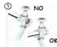
5 Vid montering använd fast- eller skiftnyckel, ej rørtång. Använd endast nödvändigt vridmoment och enbart på röränden av skjutventilen. Detta ger ett fastare grepp och undviker potentiell skada på skjutventilens hus.
