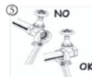
5 Vid montering använd fast- eller skiftnyckel, ej rörtång. Använd endast nödvändigt vridmoment och enbart på röränden av skjutventilen. Detta ger ett fastare grepp och undviker potentiell skada på skjutventilens hus.
