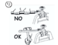
9 När överstycket monteras på skjutventilens hus är det viktigt att spanna försiktigt för att undgå att packningen mellan dessa 2 delar blir ödelagd.
