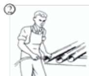
2 Rensa røret före användning. Materialrester och smuts är ofta orsaken till läckage i ventiler.
