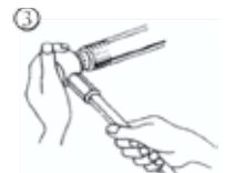
3 Avlägsna metallspån från rörändarna efter gängning. Metallspån kan förhindra tät anslutning.
