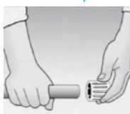
Rens røret før bruk. Materialrester og smuss er ofte årsaken til lekkasjer i ventiler.
