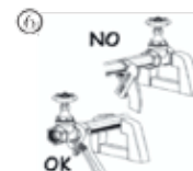
6 För att förhindra snedvridning och skada på ventilens delar, sätt ej ventilen i skruvstycke på arbetsbänk. Sätt hellre røret i skruvstycket och skruva skjutventilen på plats.
