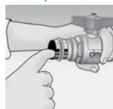
Kontroller at tetningsringene i ventilen er korrekt posisjonert. Bruk IKKE olje eller fett på tetningsringene.
