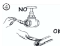
4 Använd gängtätning endast på rörgångorna, ej på skjutventilens gängor.
