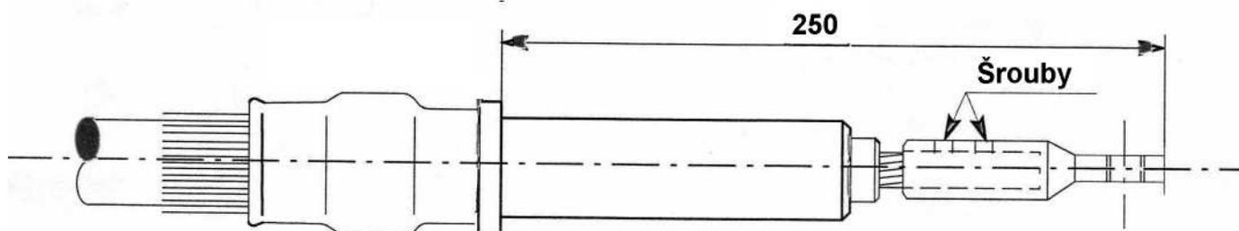
Zkontrolujte, zda je vnitřek těla konektoru čistý a potřete jej vazelínou. Rovněž potřete i povrch adaptéru a oka. Tělo konektoru opatrně nasuňte až na doraz, tj. až se ve vnitřní polovodiivé části těla konektoru objeví otvor pro připojovací šroub.
