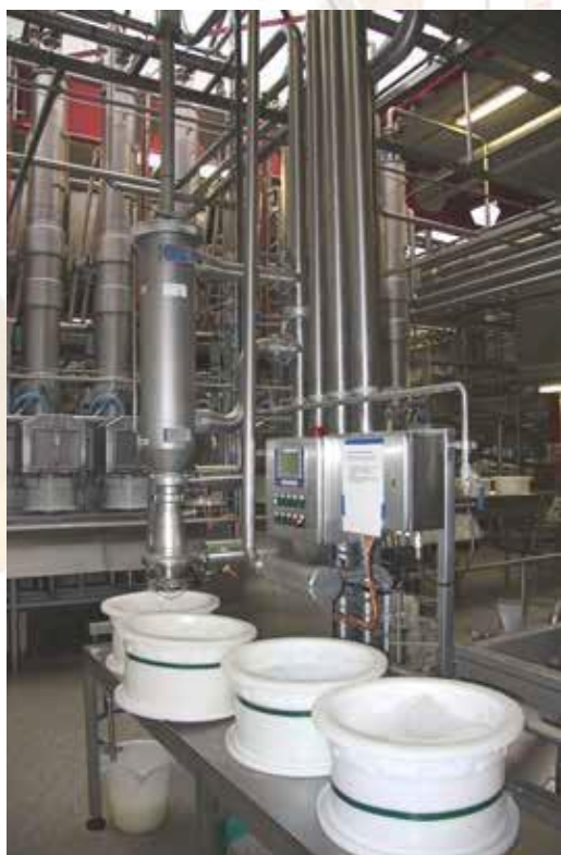
Auto-line® XLE for filtrering av massepartikler fra myse etter ost-dannelse
