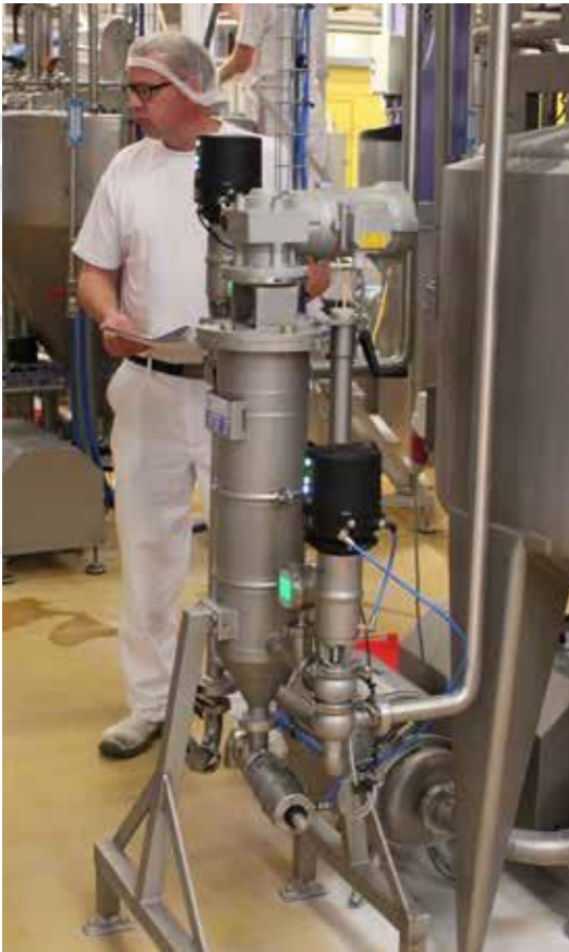
Auto-line® MLR-E for filtrering av smelteost
