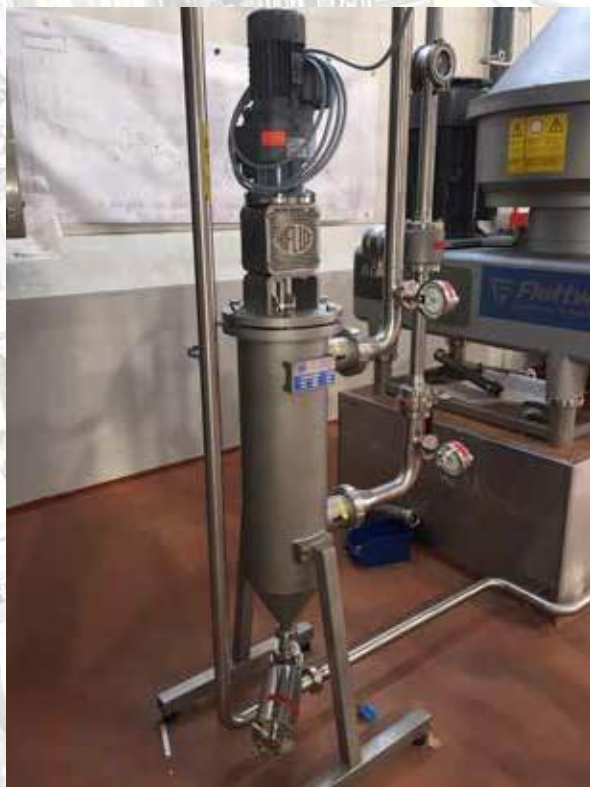
Auto-line® LR-E for filtrering av gelatinvann
