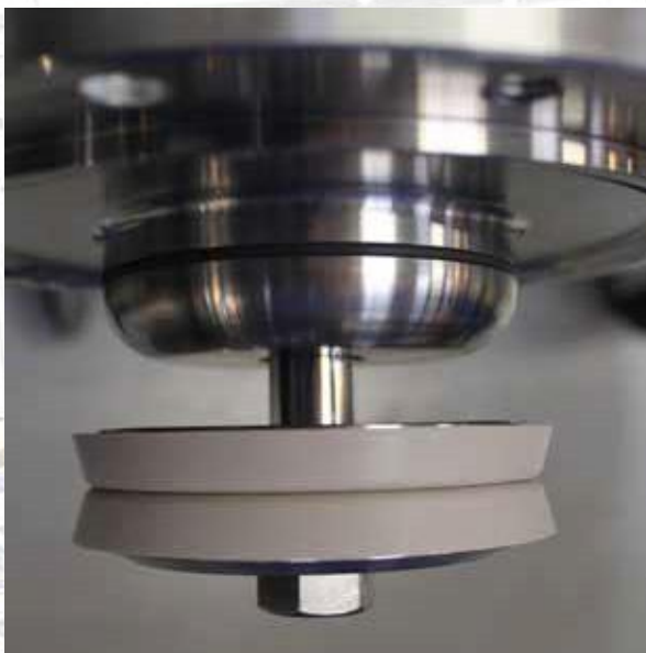
Hygienisk tetningsboks og dobbelskrapingsystem
