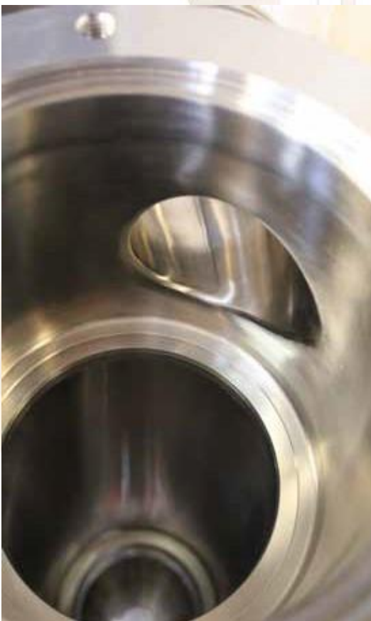
Filterhus polert til Ra 0,8 mikron
