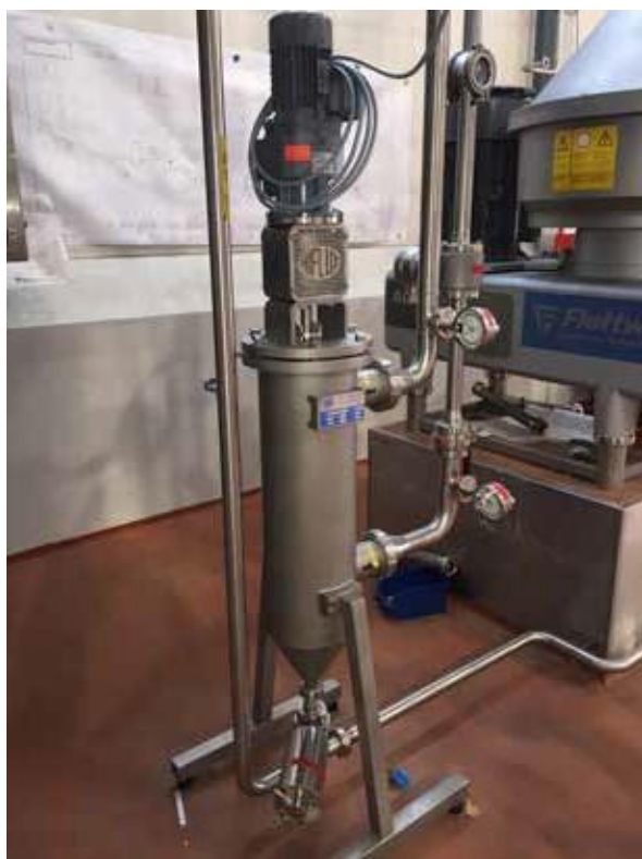
Auto-line® LR-E for filtrering av gelatinvann
