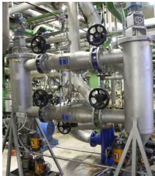
2 pk. Auto-line® XXL-R-E for filtrering av sirup fra sukkerroer
