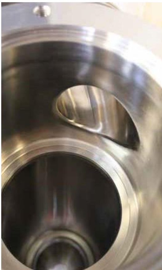
Filterhus polert til Ra 0,8 mikron
