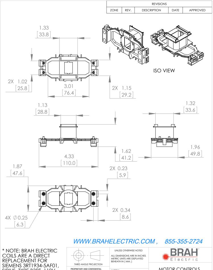
SIRIUS, TYPE B3RT, 110V AC 50HZ, SUITABLE FOR USE WITH 3RT1033, **3RT1034 CONTACTORS**
