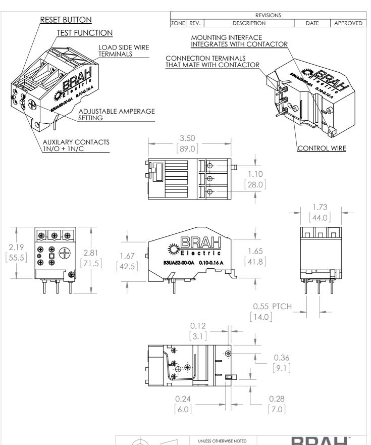
\*NOTE: THIS BRAH ELECTRIC **OVERLOAD RELAY** B3UA52-00-0A AN AFTERMARKET DIRECT REPLACMENT FOR SIEMENS 3UA52-00-0A. SUITABLE FOR USE WITH 3UA MOTOR **CONTROL SYSTEMS**
