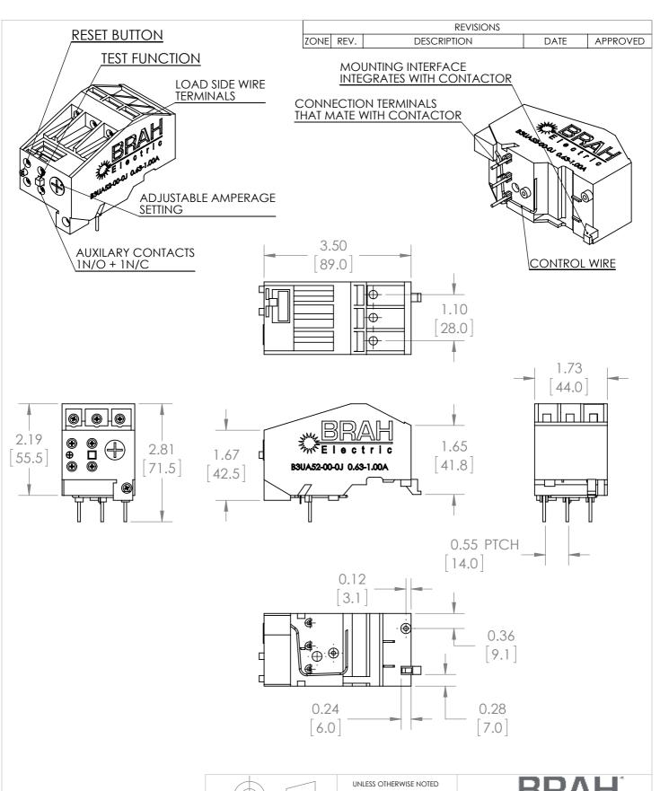
\*NOTE: THIS BRAH ELECTRIC OVERLOAD RELAY B3UA52-00-0J AN AFTERMARKET DIRECT REPLACMENT FOR SIEMENS 3UA52-00-0J. SUITABLE FOR USE WITH 3UA MOTOR CONTROL SYSTEMS
