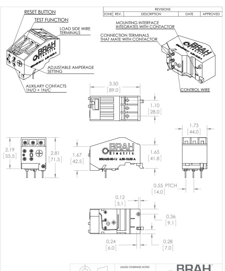
\*NOTE: THIS BRAH ELECTRIC **OVERLOAD RELAY** B3UA52-00-1J AN AFTERMARKET DIRECT REPLACMENT FOR SIEMENS 3UA52-00-1J. SUITABLE FOR USE WITH 3UA MOTOR **CONTROL SYSTEMS**
