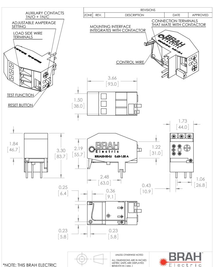
**OVERLOAD RELAY** B3UA55-00-0J AN AFTERMARKET DIRECT REPLACMENT FOR SIEMENS 3UA55-00-0J. SUITABLE FOR USE WITH 3UA MOTOR **CONTROL SYSTEMS**
