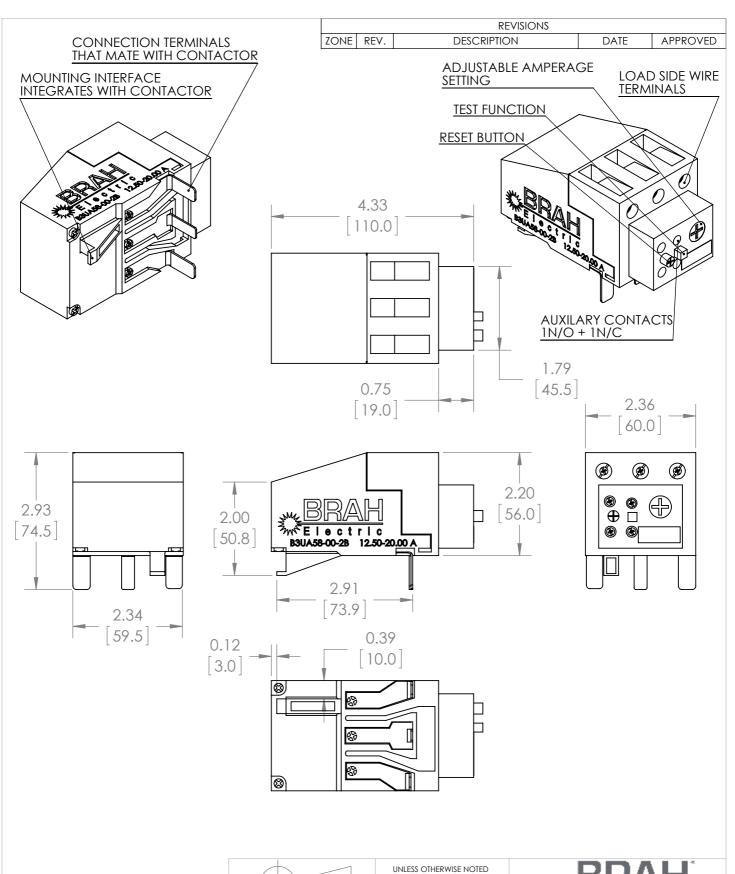
\* NOTE: THIS BRAH ELECTRIC **OVERLOAD RELAY** B3UA58-00-2B AN AFTERMARKET DIRECT REPLACMENT FOR SIEMENS 3UA58-00-2B. SUITABLE FOR USE WITH 3UA MOTOR **CONTROL SYSTEMS**
