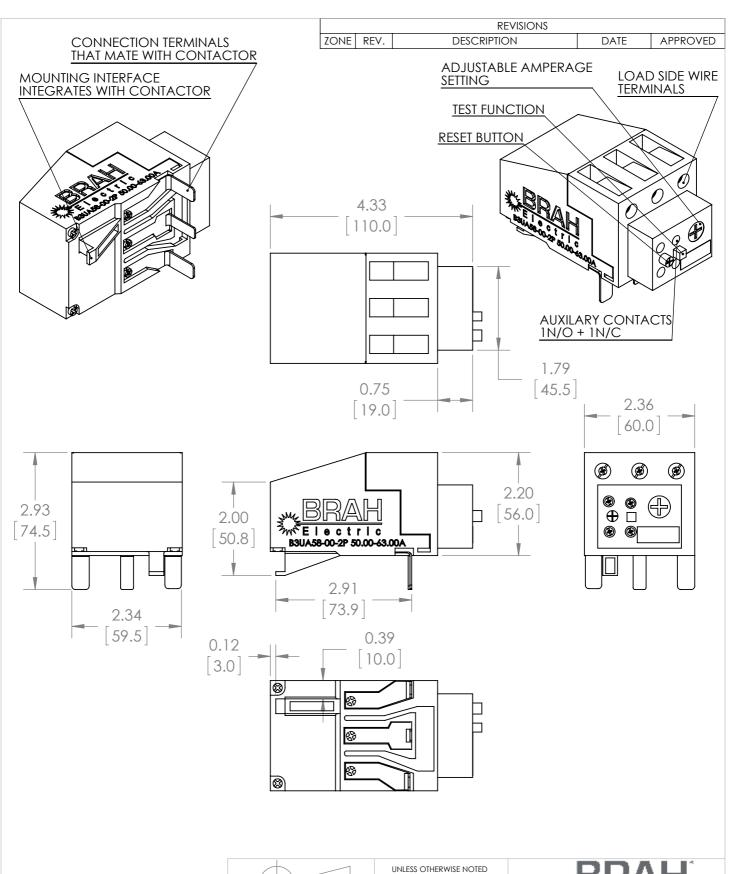
\* NOTE: THIS BRAH ELECTRIC **OVERLOAD RELAY** B3UA58-00-2P AN AFTERMARKET DIRECT REPLACMENT FOR SIEMENS 3UA58-00-2P. SUITABLE FOR USE WITH 3UA MOTOR **CONTROL SYSTEMS**
