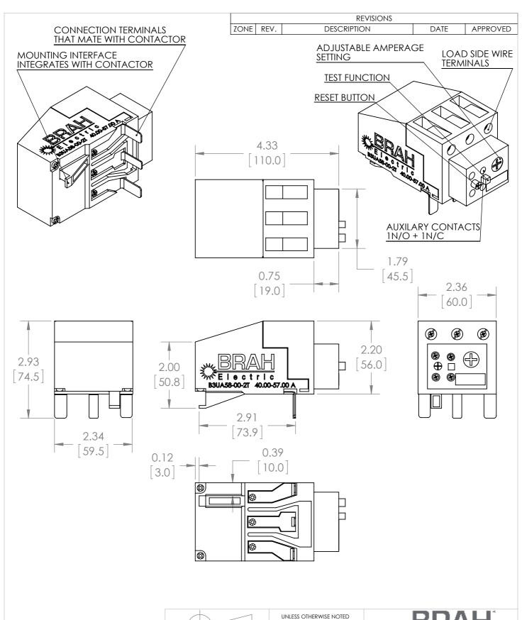
\* NOTE: THIS BRAH ELECTRIC **OVERLOAD RELAY** B3UA58-00-2T AN AFTERMARKET DIRECT REPLACMENT FOR SIEMENS 3UA58-00-2T. SUITABLE FOR USE WITH 3UA MOTOR **CONTROL SYSTEMS**
