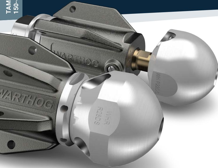
Esta boquilla está diseñada para limpiar y despejar tuberías de entre 150-450 mm. La tecnología de rotación controlada permite que los chorros penetren profundamente a través de los depósitos más duros. Además, las opciones adicionales de configuración del cabezal brindan aún más poder de jalada y descalcificación.
