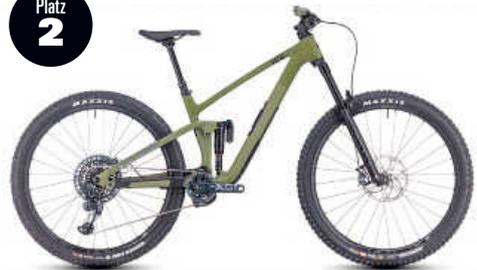
**Cube Stereo One55 – 20 %** Punktgleich teilen sich YT und Cube Platz zwei. Das All Mountain der Oberpfälzer besticht durch die Kombination von 160 Millimetern Federweg vorne, 150 Millimetern hinten und einem geringen Gewicht um 13,8 Kilo. Die Fachhändler-Preise ab 3499 Euro fürs Carbon-Bike sind fair.
