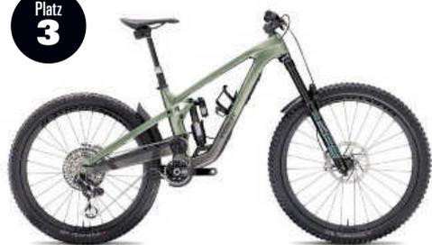
**Trek Slash – 17 %** Lang, flach, abfahrtsstark. So präsentiert sich die neueste Ausbaustufe des Enduro-Dauerbrenners mit nun 170 Millimetern Knautschzone vorne wie hinten. Ein High-Pivot-Hinterbau und zahlreiche Verstelloptionen machen das Slash zu einem 16 Kilo schweren Überflieger. Ab 4499 Euro.
