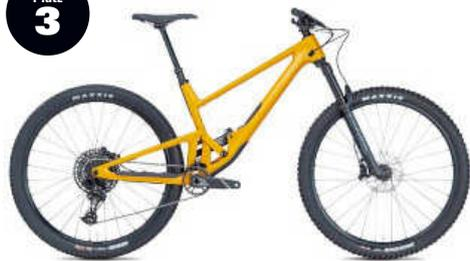
**Scor 2030 – 15 %** Das Trailbike der Schweizer zielt voll auf Fahrspaß und kommt sogar mit Bikepark-Freigabe. Scor kombiniert 120 Millimeter Federweg am Heck mit 140 an der Front und garantiert dank kurzer Kettenstreben hohen Spieltrieb. Gewicht: 13,5 Kilo. Ab 4999 Euro wechselt das 2030 den Besitzer.
