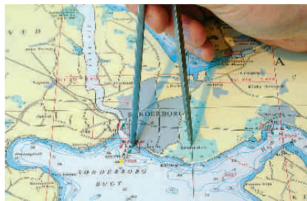
Hier wird der Abstand des gewünschten Zielortes zum nächstgelegenen Längengrad mit dem Zirkel abgegriffen
