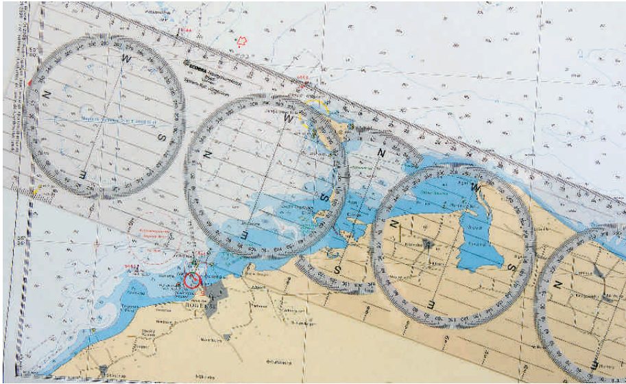
Entlang der Kurslinie wird verschoben, bis eine der Rosen an einem Meridian liegt
