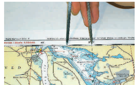
Anschließend kann am oberen Kartenrand Grad, Minute und Zehntelminute markiert und abgelesen werden
