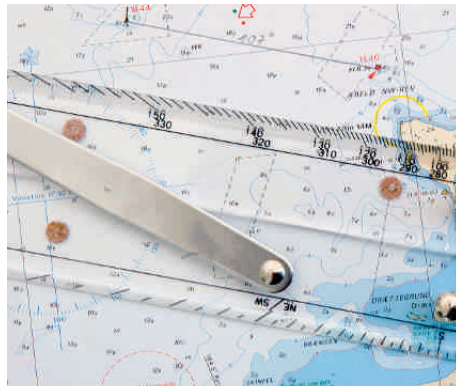
Zwei Methoden: Lineal durch die Mitte der Gradrose (o.) und am Meridian
