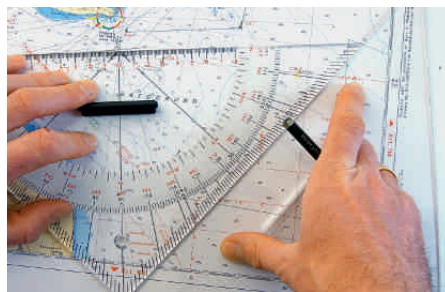
Mit dem Anlegedreieck wird der Nullpunkt auf den nächsten Meridian verschoben und die Gradzahl abgelesen
