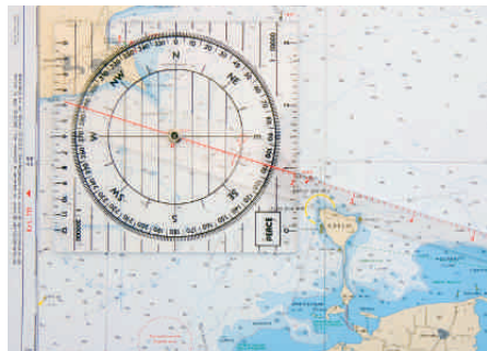
Die Position in der Mitte, zeigt ein drehbares Lineal oder eine Sehne den Kurs an
