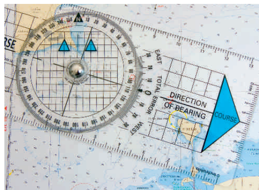
Oben das Modell aus Frankreich, unten der von der britischen RYA entwickelte Plotter. Seine Skalierung hilft bei der Stromnavigation
