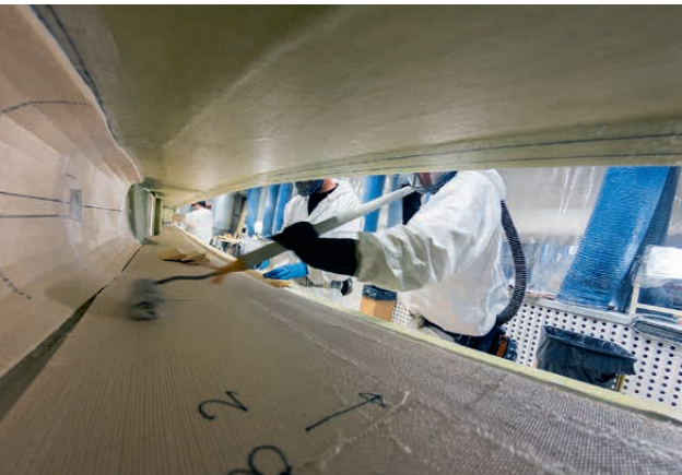
Schmale Rümpfe. Tris sind gewichtsempfindlich; bei Quorning wird das Material penibel lastgerecht eingesetzt
