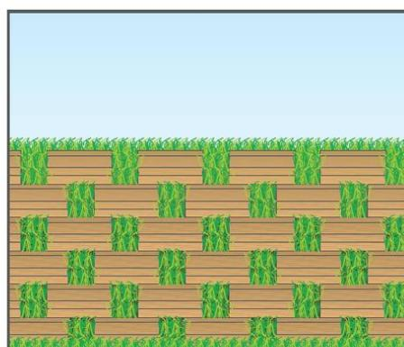
**MURO APERTO** Pezzi per mq. nr. 18,5 - Peso per mq. Kg. 481
