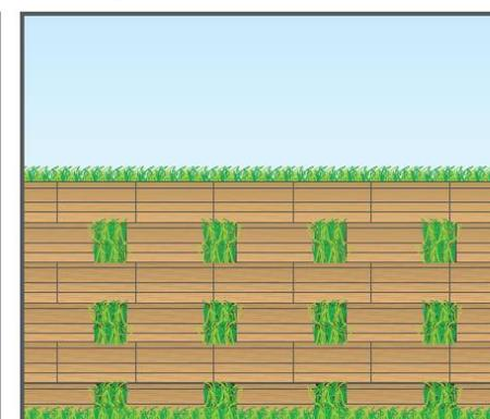
**MURO SEMIAPERTO** Pezzi per mq. nr. 22,2 - Peso per mq. Kg. 577
