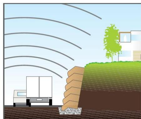
**POSA "A SCARPATA"** su fondazione in calcestruzzo posizionato nei pressi di una via carrabile. Altezza massima 1,80 m.
