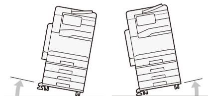
! Verrouillez toujours les roues de ce produit après l'installation. Sinon, il risque de basculer ou de glisser et de causer des blessures.
