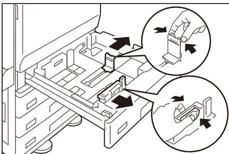
4. Ventilez une pile de papier, placez la surface à imprimer vers le haut puis chargez le papier avec les bords alignés conformément au sens de la flèche.
