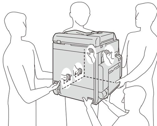
! Placez ce produit sur une surface plane et solide pouvant supporter un poids de 68 kg (configuration minimale). Sinon, si ce produit bascule, il risque de chuter et de causer des blessures.
