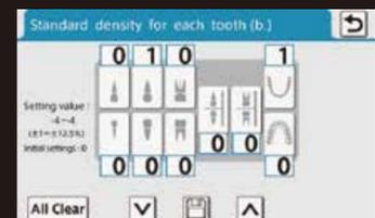
Le paramètres de rapport de densité des dents peut être ajusté à partir du paramètre par défaut pour chaque dent.
