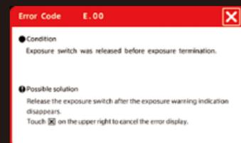
Si une erreur se produit lors de l'émission des rayons X, un message d'erreur est affiché sur l'écran de la minuterie déportée LCD, ainsi que la solution de dépannage proposée pour cet état anormal.
