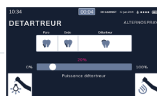
DÉTARTEUR PIÉZOÉLECTRIQUE Réglage de la puissance. Sélection des modes Paro/Endo/Détartreur. PIEZOELECTRIC SCALER Adjustable power. Perio/Endo/Scaler mode selection.
