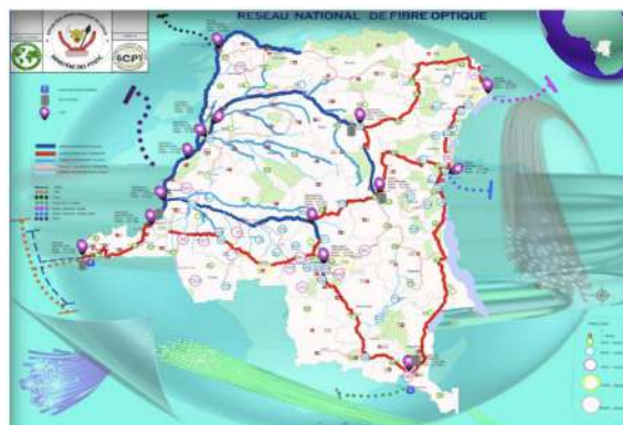
Figure 5: Topologie du projet de Backbone national de fibre optique (À mi-2025, 8160 km de fibre ont été posés, soit environ 16 % de l'objectif global de 50 000)
