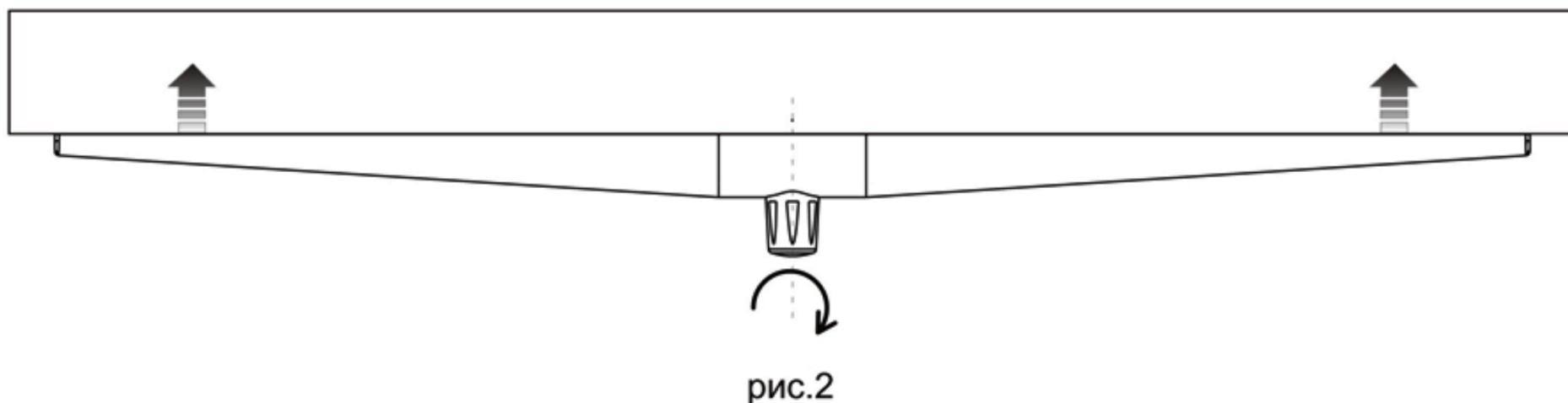
Вращая ручку клапана между этими положениями, обеспечивается плавная регулировка объема проходящего через устройство воздуха, что позволяет подобрать оптимальный режим работы.
