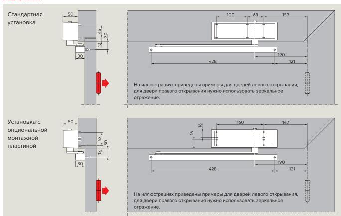
В зависимости от конструкционных условий определяется максимальный угол открывания двери от 120° до 145°.
