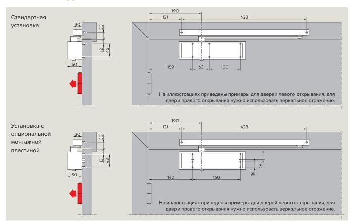
При этом типе установки возможен угол открывания 180° при условии соблюдения соответствующих строительных требований. В большинстве случаев необходимо углубление в стене.
