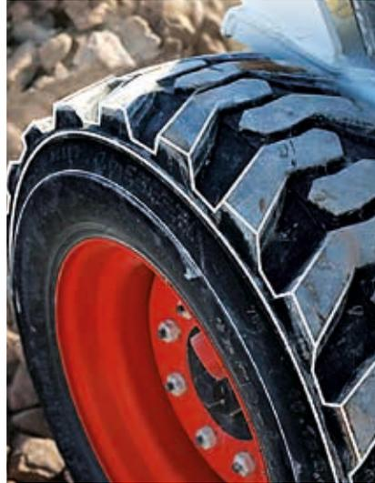
**BANDA DE RODADURA PROFUNDA PARA OFRECER LA MÁXIMA TRACCIÓN**
