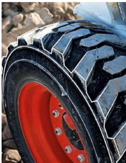
**BANDE DE ROULEMENT PROFONDE POUR UNE TRACTION MAXIMALE**
