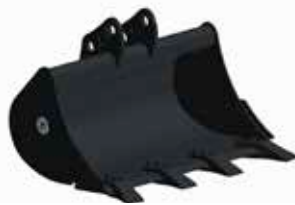
Godets : le type de raccords dépend du système d'attache.
