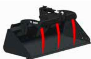
Grappins agricoles/utilitaires : à fixer sur le godet. Il est recommandé d'utiliser le clapet de sécurité secondaire 6684646 pour les modèles S450/T450 et plus.
