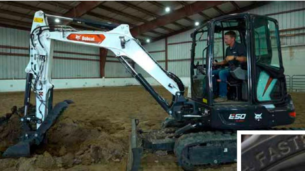
El sistema de comprobación de la profundidad es una solución que utiliza tres sensores colocados estratégicamente en la máquina para alcanzar o mantener con precisión la profundidad de terraplenado deseada desde la cabina.
