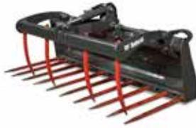
Сельскохозяйственный/универсальный захват устанавливается на вилы. Рекомендуется использовать предохранительный клапан линии 6684646 на машинах S450/T450 и более крупных моделях.
