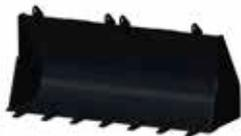
Универсальные ковши. Имеют предварительно просверленные отверстия для закрепления режущей кромки с креплением на болтах или зубьев с креплением на болтах.
