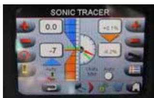
Ультразвуковая система контроля. Устанавливается на грейдерах с ACD (устройством управления навесным оборудованием) 244 см и 274 см. Погрузчик должен быть оснащен панелью Deluxe.
