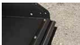
Режущая кромка на болтах
