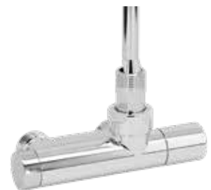
Reglerventil Lusso LR60 Vinklad För 1-rörs och 2-rörssystem. i förkromad mässing. Inklusive handratt. Levereras i 2-rörsutförande. 60 c/c. Art.nr 8737003
