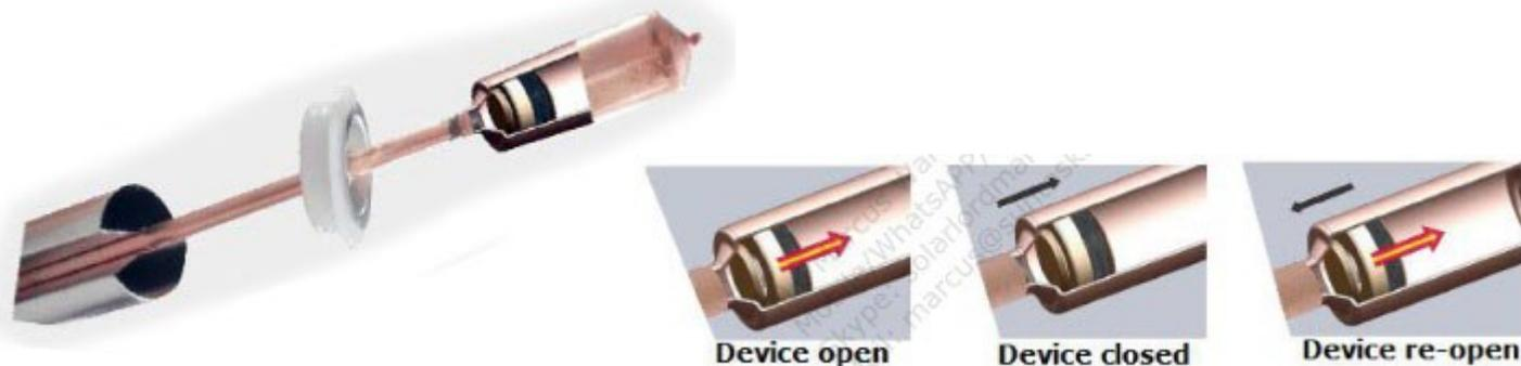
Et kobberstempel som inneholder en væske settes inn i vakuurrøret. Stempelet settes inn i en varmeveksler. Når varmen stiger i vakuurrøret, fordampes væsken i stempelet og stiger deretter oppover til den når varmeveksleren. Så avkjøles væsken og strømmer ned igjen i stempelet for å bli varma opp igjen.
